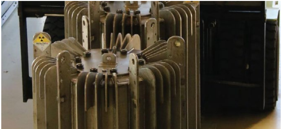
Figura 9. Contenedores para transporte de cobalto 60
