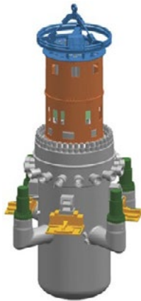
Figura 3. Esquema del SMR ACP100
