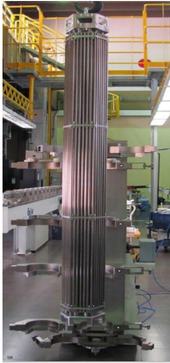
Figura 10. Barra de elemento combustible reactor CAREM
